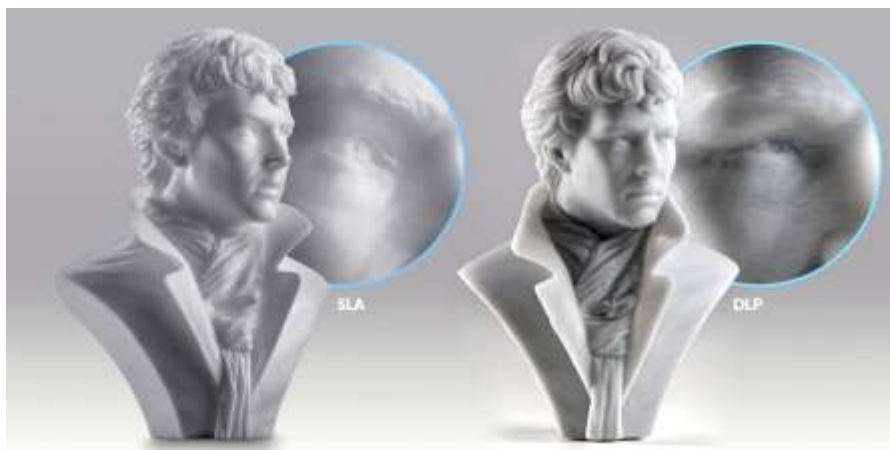
Рис. 1.6 Внешний вид распечаток SLA и DLP [4]
