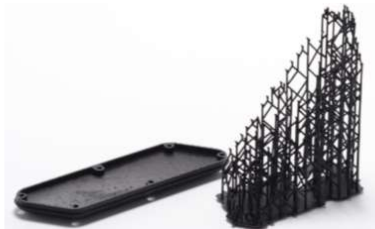
Рис. 1.3 Деталь, напечатанная в SLA после удаления несущих конструкций
